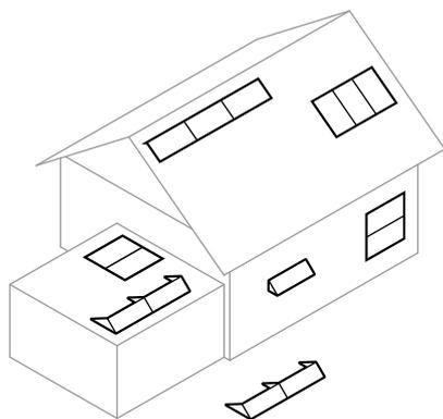
Bei Montage an Fassaden oder liegend auf Flachdächern empfehlen wir, die Kollektorfläche 20 bis 30% größer auszulegen.
