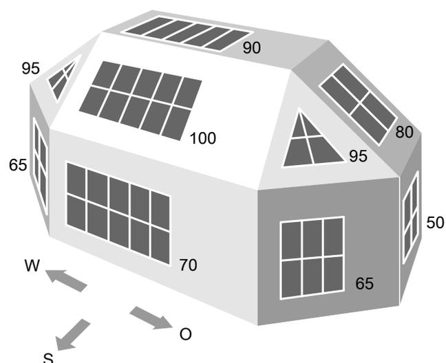
In Abhängigkeit von der Anbringung der Kollektoren (Montageart) variiert der Ertrag. Ein geneigtes Süddach bringt die höchsten Erträge. Ein Ost- oder Westdach dagegen nur ca. 80%.
