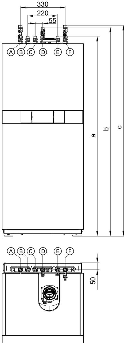
Anschluss-Set mit Vormontagekonsole zur Vorinstallation im Rohbau, Best.-Nr. 7355 317
